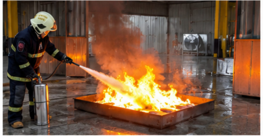
16:00:04 เริ่มฉีดสารดับเพลิง LCF-500 ที่อุณหภูมิ 1,270°C
